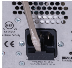
Extracción de portador de fusibles
