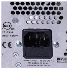
Module d'entrée d'alimentation Retrait du porte-fusibles
